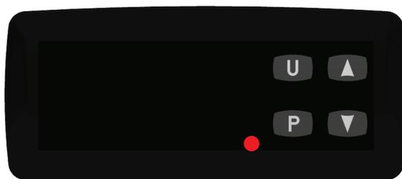
Per attivare il funzionamento del termostato premere per 3 secondi il tasto “U” e il display si accende.
