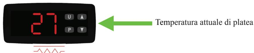
Se si desidera modificare la temperatura di CIELO o di PLATEA, premere una volta il tasto freccia giù “▼” del termostato corrispondente e viene visualizzato la scritta “SP1” lampeggiante e successivamente visualizza la temperatura di SET POINT impostata.
