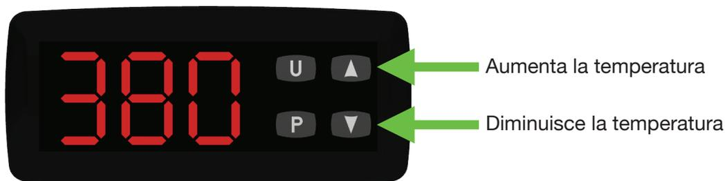
Tenere premuto i tasti con la freccia su o giù per aumentare o diminuire velocemente il valore della temperatura da impostare.
